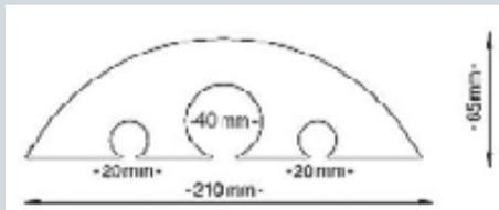
Version noire: pour tuyaux et câbles de Max. Ø 75 mm, avec bande réfléchissante modèle RA 3. Utilisables des deux côtés. Éléments modulaires, extensibles à volonté par simple emboîtement.
