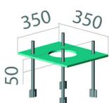
Le gabarit reste en place de niveau et doit reposer entièrement sur massif béton.
