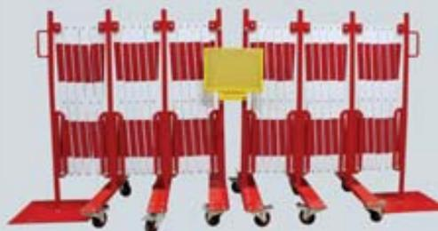
**Barrière extensible, set de 2 pièces, 8000 mm par pièce avec socle 400 x 300 x 6mm aux extrémités, version massive, acier plat 40 x 5 mm, galvanisée et thermolaquée, roues avec roulements à billes, 6 roulettes de 500 mm de large avec dispositif de blocage, écrous autobloquants, poignées, élément central de liaison permettant aussi d'afficher une note d'information A4**
